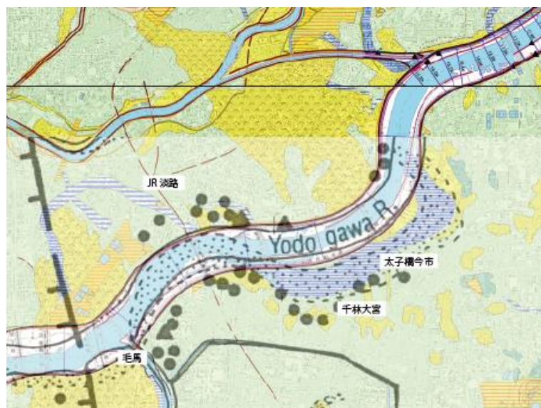
図-5 守口付近の治水地形分類図 1) と三田村他(1996) 4) 図中の青横縞が治水地形分類図の旧河道を示す
